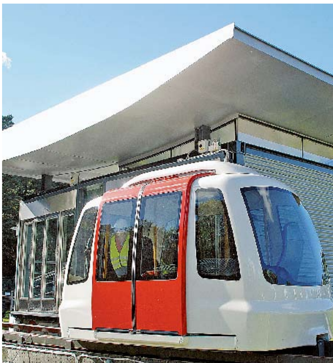
Spårbilar är förarlösa, automatstyrda vagnar som kör på ett spårssystem ovanför marken.
